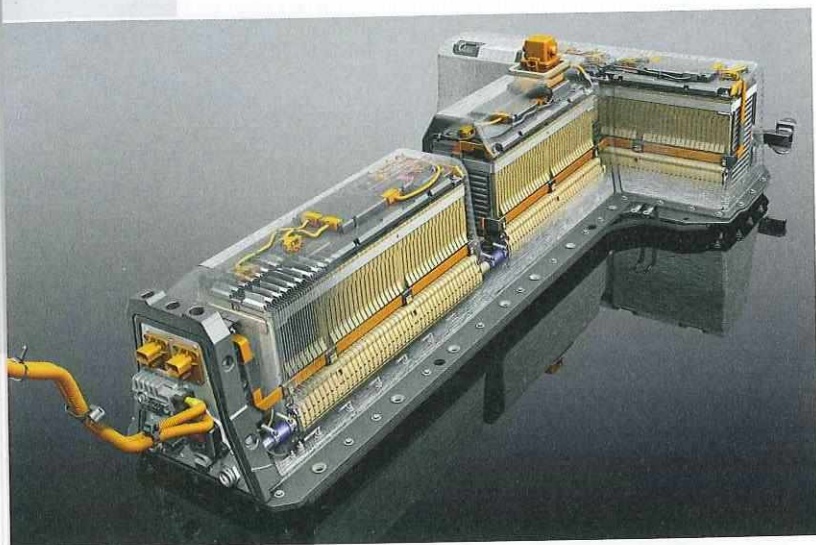
Schwerer Stromsammeler: Die insgesamt 288 Zellen der 198 kg schweren Lithium-Ionen-Batterie bieten ein Speichervermögen von 16 kWh.
