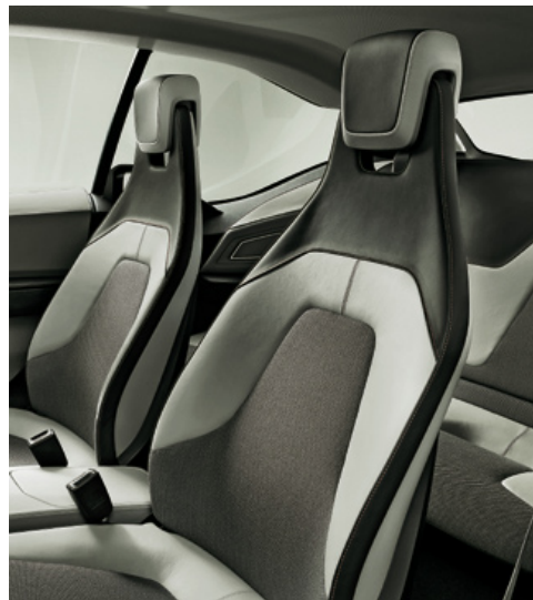
Schmale Lehnen: Sitze aus einem Mix aus Wollgarn und einem Monofill-Werkstoff
