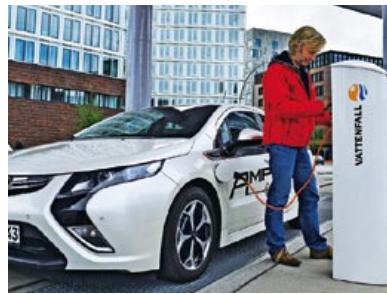
Der Ampera lässt sich zu Hause oder an öffentlichen Stromtankstellen aufladen. Seine Batterie fasst 16 Kilowattstunden
