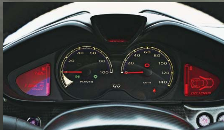
Mal zwei: Im Cockpit befindet sich die Tankanzeige für den Benziner (li.) und die Restkapazität der Akkus (re.). Macht zusammen 480 Kilometer Reichweite
