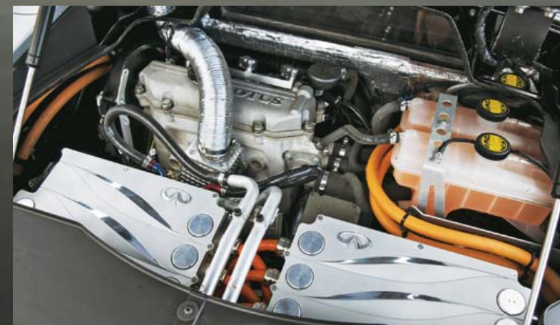
Lauter Rabauke: Der kleine Dreizylinder von Lotus ist direkt hinter dem Fahrer montiert – und krakeelt mangels Dämmung lautstark, sobald die Akkus leer sind
