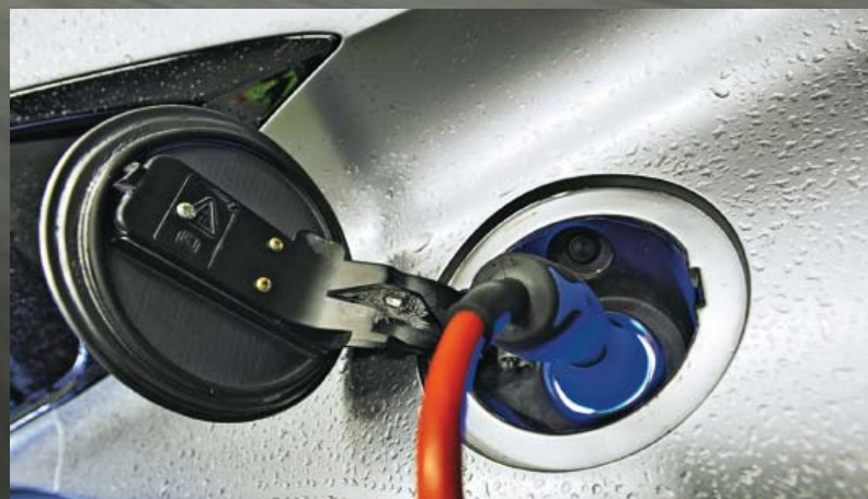
Anders tanken: Wenn die 14,8 Kilowattstunden großen Akkus nach 50 Kilometern leer sind, kann der Emerg-e binnen fünf Stunden wieder aufgeladen werden
